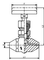
Hochdruck-Absperrventil, beiderseits Anschweißende, Material: 1.0460, 1.4571, 1.7335
