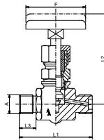
Hochdruck-Absperrventil, beiderseits BSPP Außengewinde, Material: 1.0460, 1.4571, 1.4104, 1.7335
