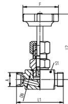
Nadelventil, beiderseits Schneidringanschluss, schwere Reihe, Material: 1.4571
