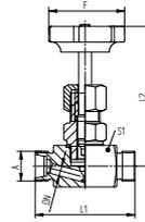
Nadelventil, beiderseits Schneidringanschluss, leichte Reihe, Material: 1.4571
