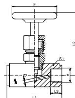
Nadelventil, beiderseits Innengewinde, Material: Stahl, 1.4571
