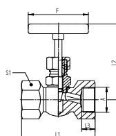
Nadelventil, beiderseits Innengewinde, Material: Messing
