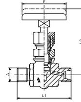
Hochdruck-Absperrventil, beiderseits Schneidringanschluss, leichte Reihe, Material: 1.0460, 1.4571, 1.4104
