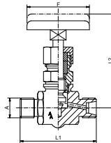
Hochdruck-Absperrventil, beiderseits Schneidringanschluss, schwere Reihe, Material: 1.0460, 1.4571, 1.4104
