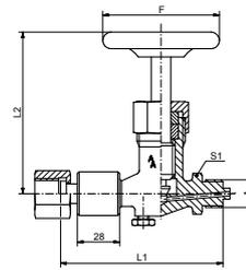
Manometer-Absperrventil, DIN 16270, Zapfen x Schaft für Messgerätehalter mit loser Mutter
