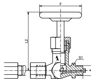
Manometer-Absperrventil, DIN 16271, Zapfen x Spannmuffe x Prüfzapfen M20 x 1,5
