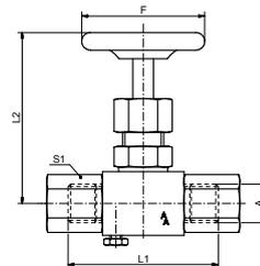
Manometer-Kleinabsperventil, Spannmuffe x Anschlussmuffe
