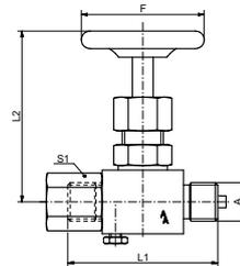
Manometer-Kleinabsperventil, Zapfen x Spannmuffe
