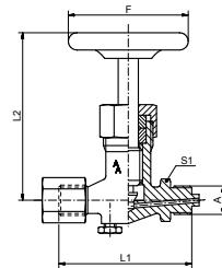
Manometer-Absperrventil, DIN 16270, Zapfen x Spannmuffe
