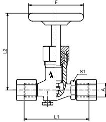
Manometer-Absperrventil, DIN 16270, Spannmuffe x Manometeranschlussmuffe mit Steg
